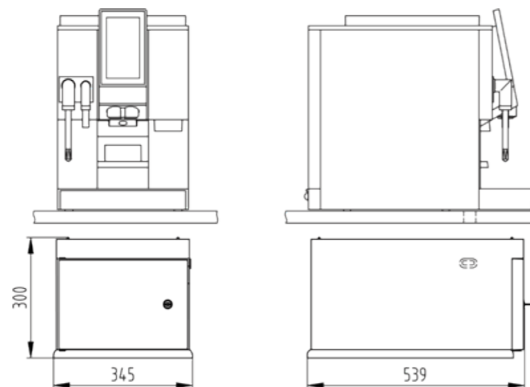
Unterstellkühlleinheit unter Kaffeemaschine
